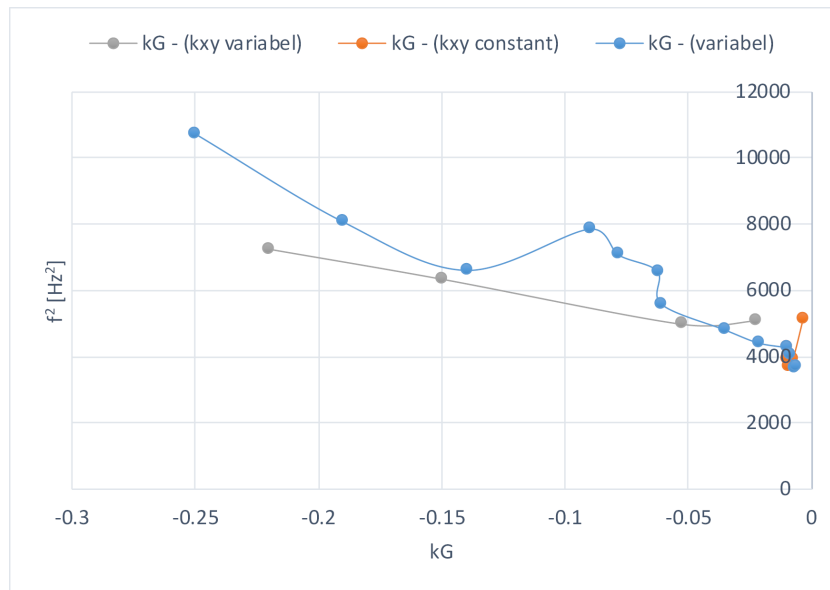
Figuur 4.15: Dubbele kromming met twist: f(\text{ansys})^2 [Hz 2 ] uitgezet tegenover negatieve k_G
