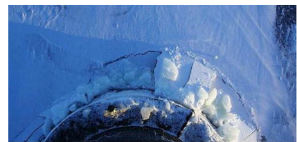
FIGUUR 2.4: BEZWIJKEN IJSPLAAT ONDER BUIGING (PRABHAKAR, VAN NES, CORONA, 2009)
