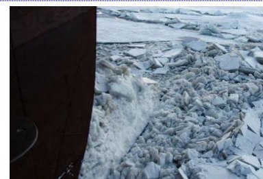
FIGUUR 2.5: BEZWIJKEN VOLGENS “MIXED MODE” (G.W. TIMCO, 2005)
