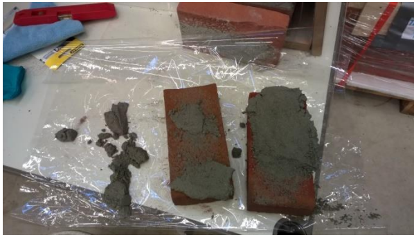
Figuur 6 - 1-minuut en 10-minuut hechtproef
