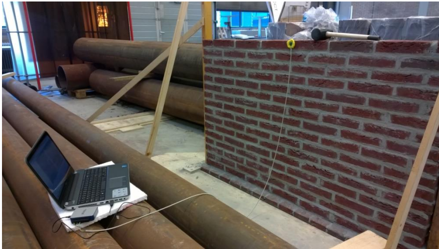
Figuur 15 - Opmeten versnelling
