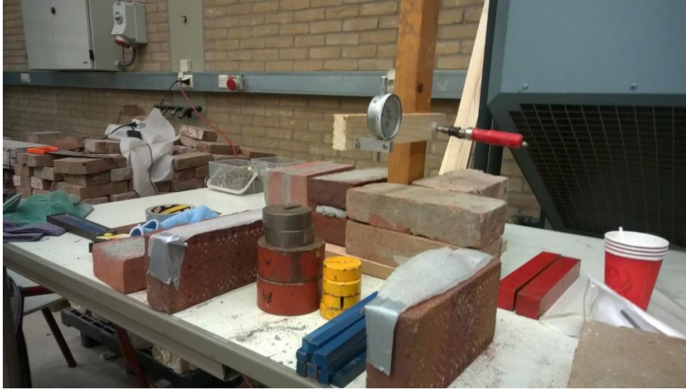
Figuur 9 - Meetklokje, gewichten en steunpunten met daarop plastic foam geplakt
