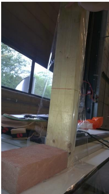
Figuur 7 – Opstelling proefstuk buigtrekproef
