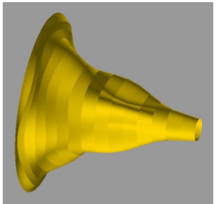
Figuur 24 trillingsvorm, straal 1 m, dikte 2 mm
