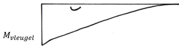
Figuur 12. Schets van de momentenlijn van de vleugel
