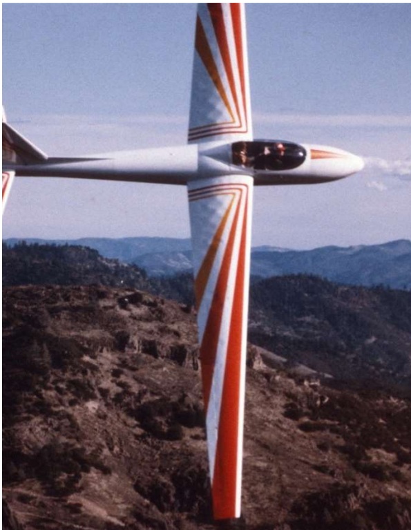
Figuur 9. Afbeelding van een zweefvliegtuig die rond een bergtop vliegt, waarbij in beide vleugels aan de bovenzijde een initiële knikvorm te zien is (Indrebo)
