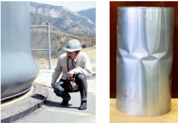
Figuur 4. Links een olifantsvoet en rechts een Yoshimura patroon (Hoogenboom, Handout 12, 2022)
