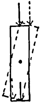
FIGUUR 4: EFFECT AANGRIJPINGSPOINT BELASTING OP EFFECTIEVE KIPLENGTE
