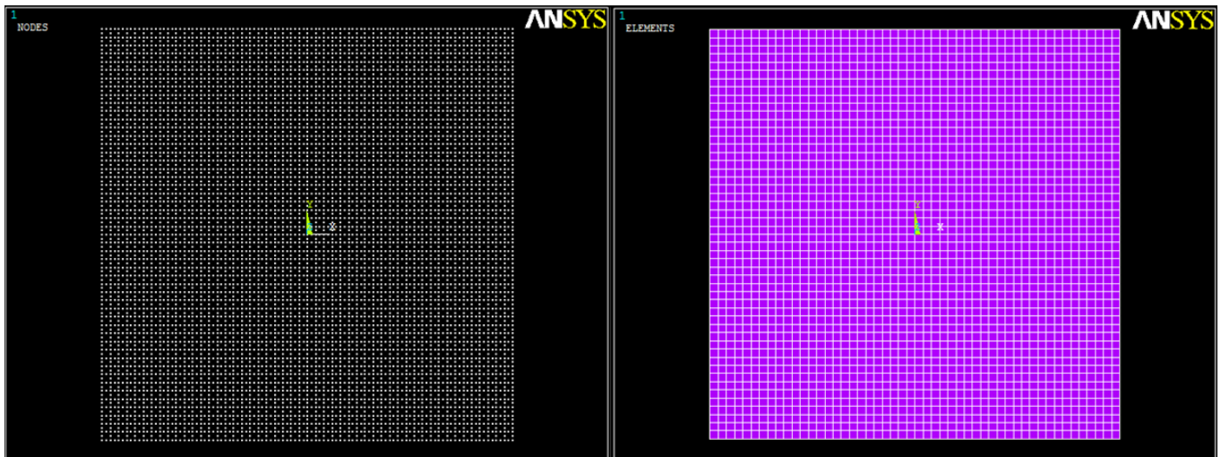
Figuur 1.7: 2-D vierkant knoppennetwerk voor element met acht knopen, 50 bij 50 elementen (links knopen, rechts elementen, nulpunt in het midden)
