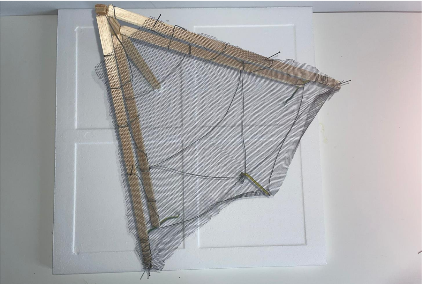
Figuur C 12: Bovenaanzicht gehele schaalmodel met kunststof gaas.
