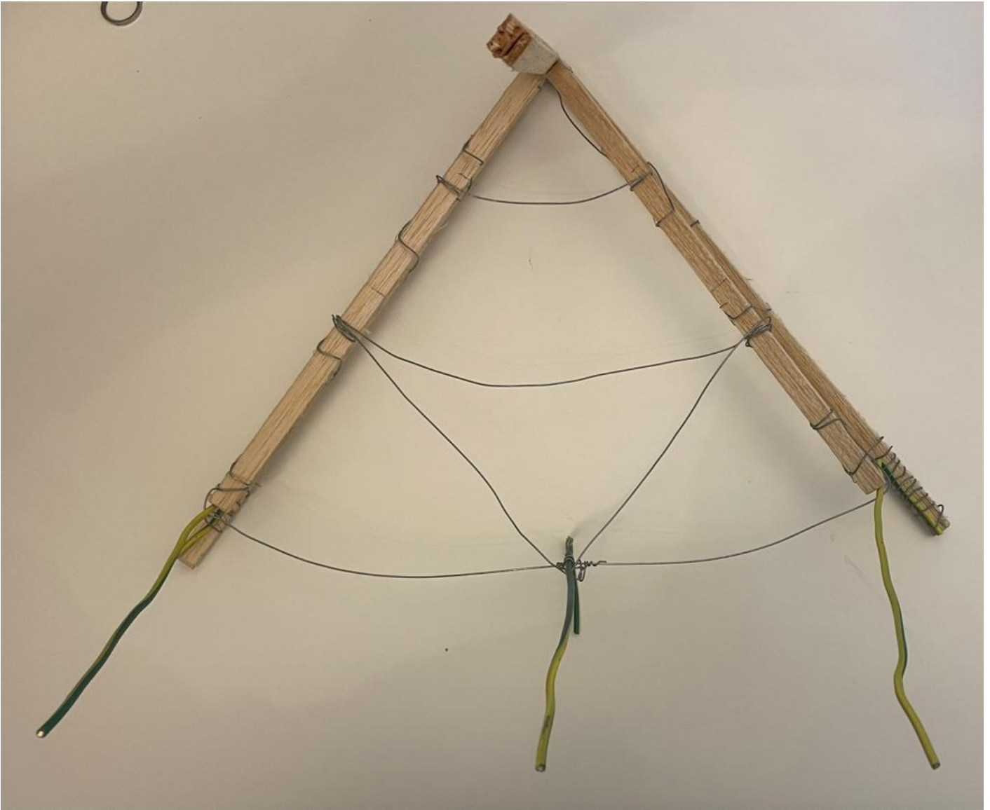
Figuur C 10: Onderaanzicht onderliggende constructie van het schaalmodel.
