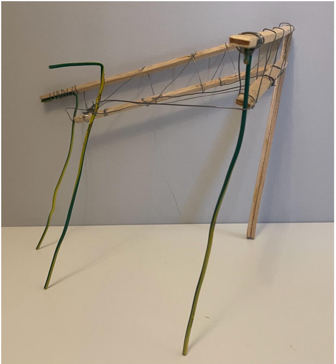
Figuur C 11: Zijaanzicht onderliggende constructie van het schaalmodel.
