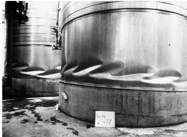
Figuur II Uitknikken schaalconstructie (Skogh, 1979)
