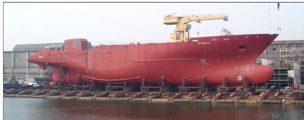
Figuur 1: Negatieve en positieve kromming in de boeg van een schip in Gdansk, Polen. [F1]
